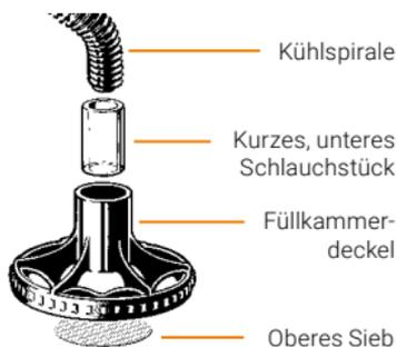
Die Kühlspirale mit einer leichten Drehbewegung aus dem Füllkammerdeckel herausziehen und anschließend das Schlauchstück von der Kühlspirale abziehen.
