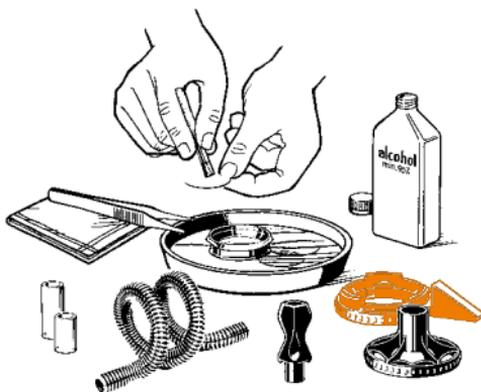
Manuelle Reinigung mit Alkohol (min. 90%) oder Spülmittel. Die Kühlspirale kann auch nachgekauft werden.
