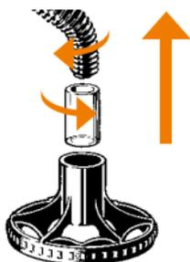
*Kühlspirale aus dem Füllkammerdeckel herausziehen*
