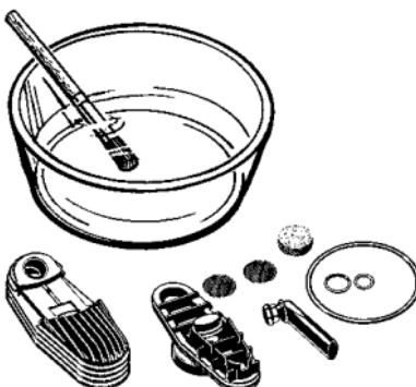
Handmatige reiniging van de gedemonteerde Koeleenheid
