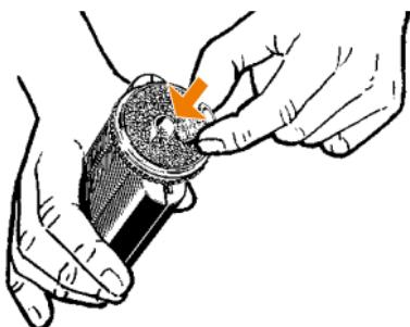
Remplir la Chambre de Remplissage avec l'Accessoire de Remplissage
