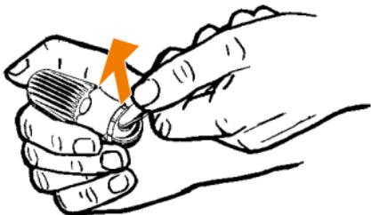
Verwijderen van het Mondstuk uit het Koeleenheiddeksel
