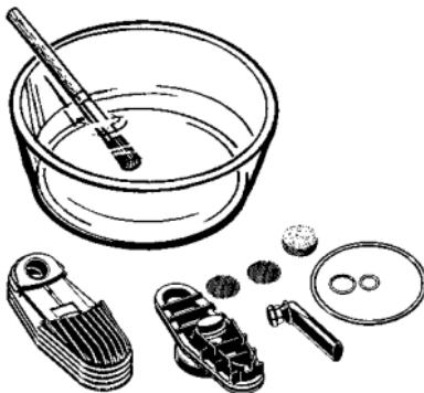
Nettoyage manuel de l'Unité de Refroidissement démontée
