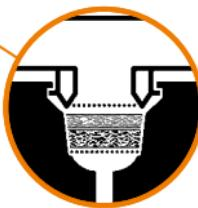
*Chambre de Remplissage partiellement remplie avec Coussinet à Gouttes superposé*
