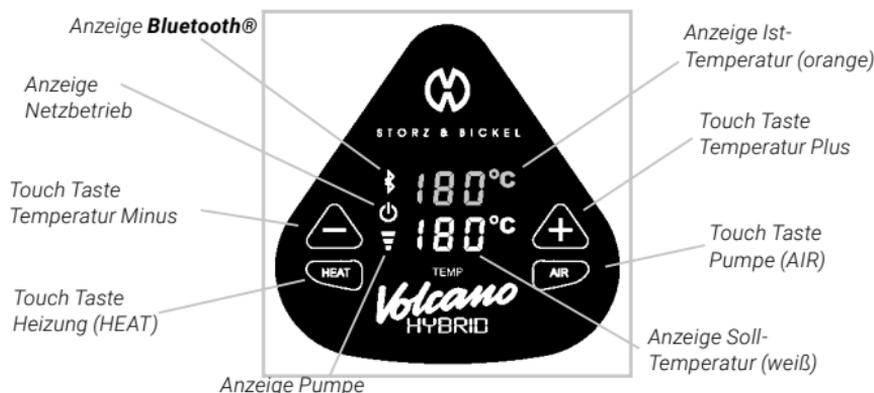
Durch kurzes Antippen der Touch Taste Temperatur Plus oder Minus werden die Soll-Werte in 1-Grad-Schritten in die entsprechende Richtung geändert. Durch dauerhaftes Drücken der Touch Taste Temperatur Plus oder Minus beginnen die Soll-Werte stetig in die entsprechende Richtung zu laufen. Bei gleichzeitigem Betätigen der Touch Taste Temperatur Plus und Minus wechselt die Anzeige von Grad Celsius auf Grad Fahrenheit und umgekehrt.
