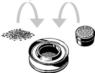
*Füllkammerreduzierer direkt mit zerkleinertem Pflanzenmaterial oder mit einer befüllten Dosierkapsel befüllen*
