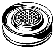
La Capsule de Dosage installée dans le Réducteur de la Chambre de Remplissage
