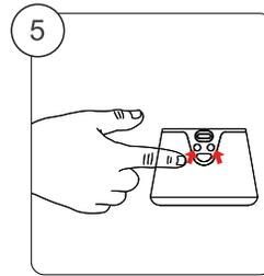
**STEP 5:** Drücken Sie die (+) oder (-) Taste, um die gewünschte Temperatur einzustellen. Die Temperatur ist in dem Bereich von 148°C - 482°C (300°F - 900°F) einstellbar.
