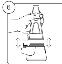
**STEP 6:** Richten Sie die Einlassöffnung an der Vorderseite des Glases mit dem Verdampfer aus. Glasaufsatz vorsichtig in die Basis setzen.
