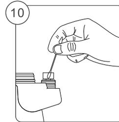
**STEP 10:** Reinigen Sie das Gerät nach jeder Benutzung mit einem Wattestäbchen oder Isopropylalkohol.
